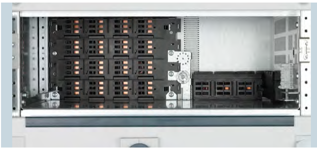
Abb. 4/14: Fach für Normaleinschub HFD
